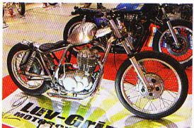
ベアメタルのSRはLuv-Grinds製作。ヘッドライトにフォグランプを流用。
